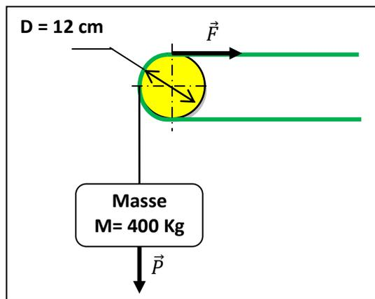
La force tangentielle développée sur le rouleau du tapis est équilibrée par une masse de **400 Kg**. On donne :  $g = 10 \text{ ms}^{-2}$ .
