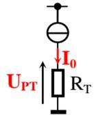
$$\begin{cases} R_T = R_0(1 + \alpha T) \\ \alpha = 3,85 \cdot 10^{-3} \text{ } ^\circ\text{C}^{-1} \\ R_0 = 1000 \text{ } \Omega \text{ à } T = 0^\circ\text{C} \end{cases}$$
